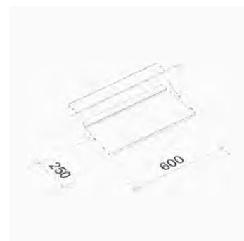
T-WAD-600/250 Auslaufbreite: ca. 600 mm Auskragung: ca. 250 mm
